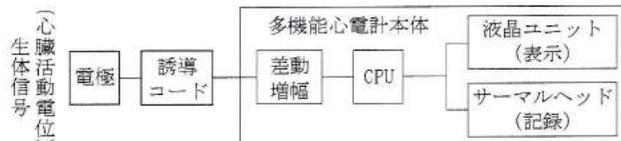
体表面に付けた電極より誘導コードを介して導かれた生体信号(心臓の活動電位)は、作動増幅器でノイズ等同相成分を除去した心電図信号となった後、A/Dコンバータでアナログ信号からデジタル信号に変換されCPUへ送られます。CPUで処理されたデータはサーマルヘッドに送られ記録紙に記録されます。
